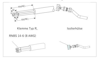
3. Schließen Sie die Kabel an die AC-Klemmleiste an und befestigen Sie sie (4 ... 5 Nm). Ziehen Sie dann die Sicherungsmuttern der Klemme fest (7 ... 8 Nm):
