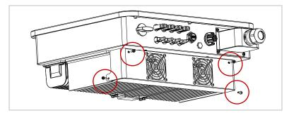
3 Lösen Sie die Schrauben an der Lüfterposition (15-17KTLX-G3 Modelle haben einen Lüfter, 20-24KTLX-G3 Modelle haben zwei Lüfter), ziehen Sie die Klemmen an der Schnittstelle zwischen Lüfter und Wechselrichter ab und nehmen Sie den Lüfter heraus:
