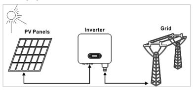
SOFAR 15K ... 24KTLX-G3 Wechselrichter dürfen nur mit Photovoltaik-Modulen verwendet werden, die keine einpolige Erdung erfordern. Der Betriebsstrom darf im Normalbetrieb die in den technischen Daten angegebenen Grenzwerte nicht überschreiten. An den Eingang des Wechselrichters dürfen nur Photovoltaikmodule angeschlossen werden (keine Batterien oder andere Stromversorgungsquellen).
