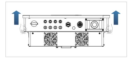
2. Heben Sie den Wechselrichter aus der Verpackung und bringen Sie ihn in die Installationsposition.
