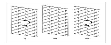
3 Hängen Sie den Wechselrichter in die Wandhalterung ein. Sichern Sie den Wechselrichter mit den Sechskantschrauben M6 an der Wandhalterung.
